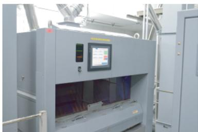
BG 無洗米から、小石、着色粒、金属、ホコリなどの異物を完全に除去します。
