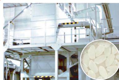
BG 無洗米機により、精白米から肌ヌカを取り除き、BG 無洗米にします。
